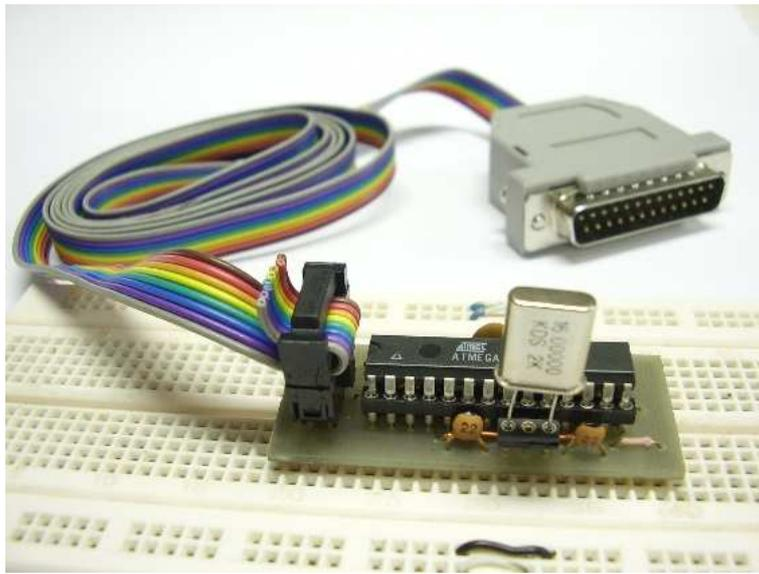
Figura 2: Foto do circuito de referência para protoboard e gravadora BSD.
