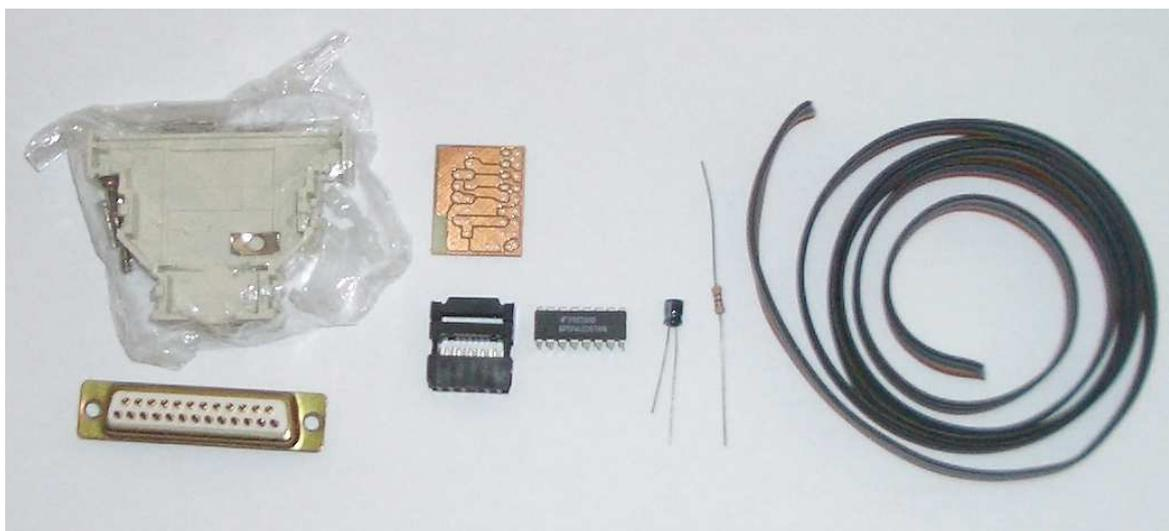
Figura 4: Material para montagem da gravadora BSD
