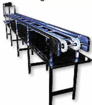
Figura 12: Esteira contadora com sensor óptico
