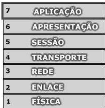
Figura 1: Camadas do modelo OSI.
