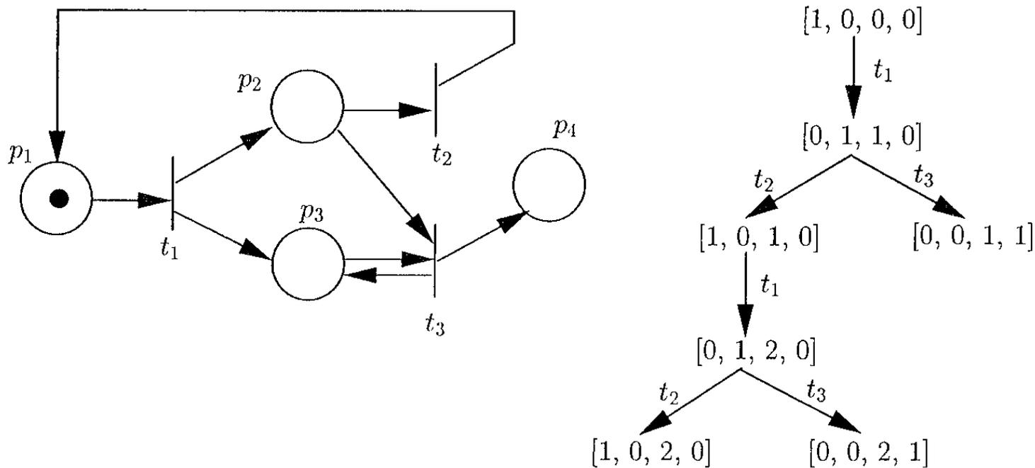
Figura 3: RdP ilustrando estados terminais e cobertos em uma árvore de alcançabilidade
