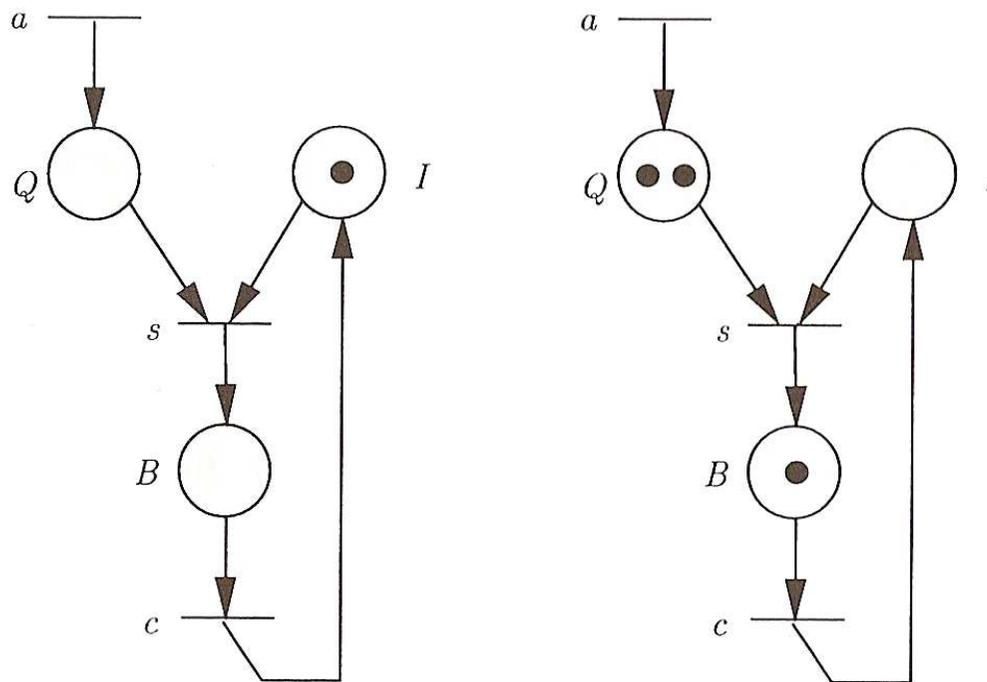
Figura 1: Q: Fila de entrada; B: Em processamento; I: Máquina disponível.
