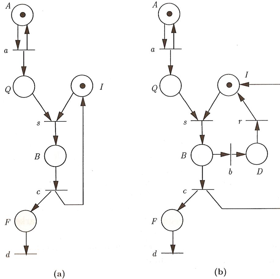
Figura 2: Q: Fila de entrada; B: Em processamento; I: Máquina disponível; F: Produtos concluídos; D: Quebra da máquina.
