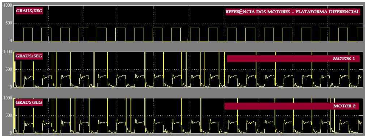
Figura 3.34: Resposta no tempo dos motores da plataforma diferencial.
