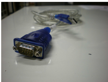
Figura 2.23: Cabo conversor USB/SERIAL.
