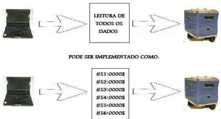
Figura 3.8: Transmissão de mais de um dado do tipo float através de múltiplas mensagens.
