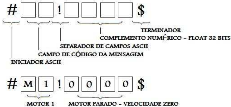
Figura 3.7: O protocolo flexível de comunicação para implementação da conversa EEEPC-ARM.
