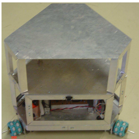
Figura 1.1: Robô móvel omnidirecional ROHL desenvolvido no LARA em 2005
