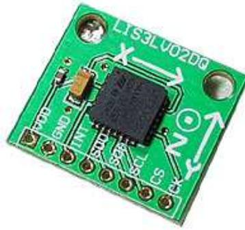
Figura 3.15: Acelerômetro de três eixos LIS3LV02DQ usado nesse trabalho.
