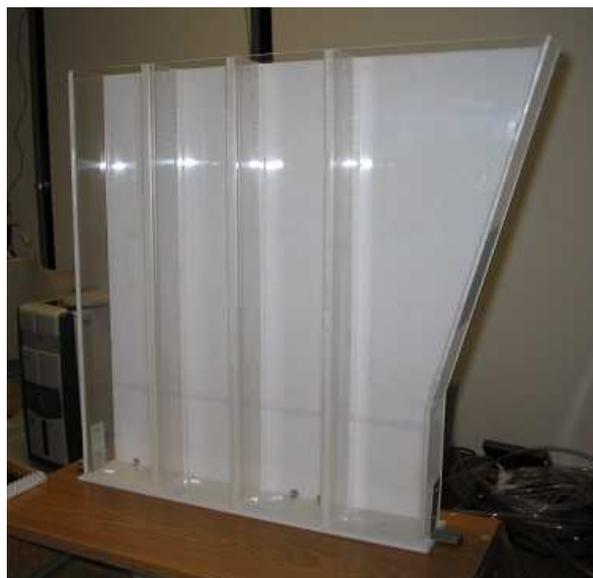
Figura 1.3 – Novo sistema de nível de líquidos do LAVSI (Sistema de Nível de Líquidos de Quarta Ordem).
