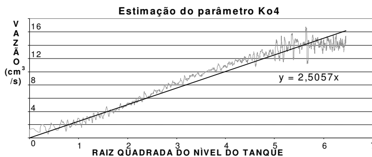
Figura 4.6 – Gráfico utilizado para a estimativa do parâmetro K_{o4} , que é obtido a partir da inclinação da reta que melhor aproxima os pontos.
