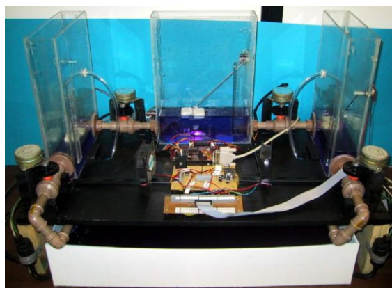
Figura 1.1 – Primeiro Sistema de Nível de Líquidos do LAVSI (Sistema de Nível de Líquidos Multivariável).
