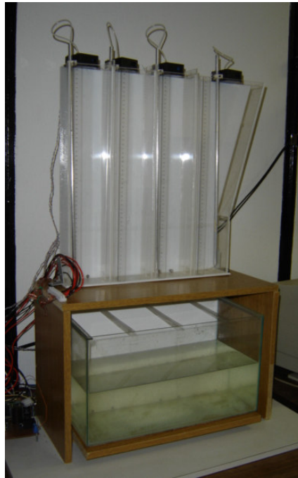
Figura 3.1 – Foto do novo sistema de Nível de Líquidos do LAVSI.
