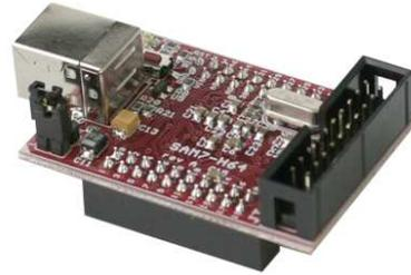
Figura 3.4: Placa do microcontrolador
