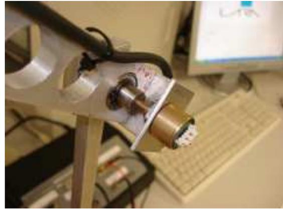
Figura 3.42: Codificador magnético absoluto MA2-P
