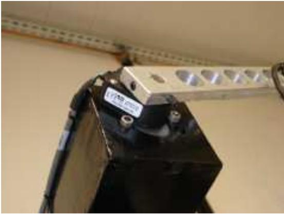
Figura 3.41: Codificador óptico incremental E5S
