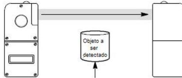
Figura 2.6: Esquemático de um sensor de fecho transmitido em operação
