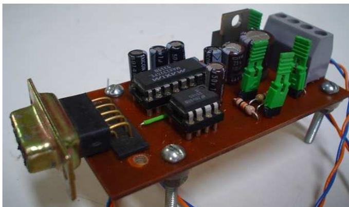
Figura 3.27: Placa de interface de comunicação entre o PC e a prótese.
