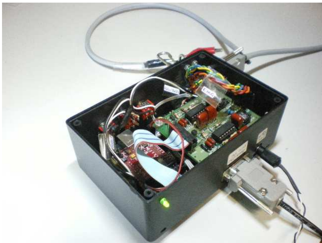
Figura 3.1: Caixa com circuitos desenvolvidos para captação dos sinais EMG, estabelecimento do barramento RS485, comunicação com PC e interface com o usuário.
