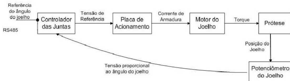
Figura 3.10: Diagrama de blocos da arquitetura de controle do joelho.
