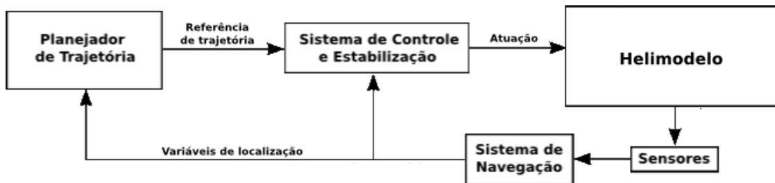
Figura 2.1: Arquitetura geral de um robô helicóptero.
