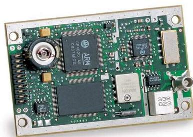
Figura 3.4: Receptor GPS SuperStarII fabricado pela *NovAtel*®
