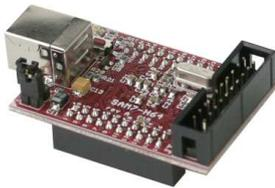
Figura 3.10: Placa contendo Microcontrolador AT91SAM7
