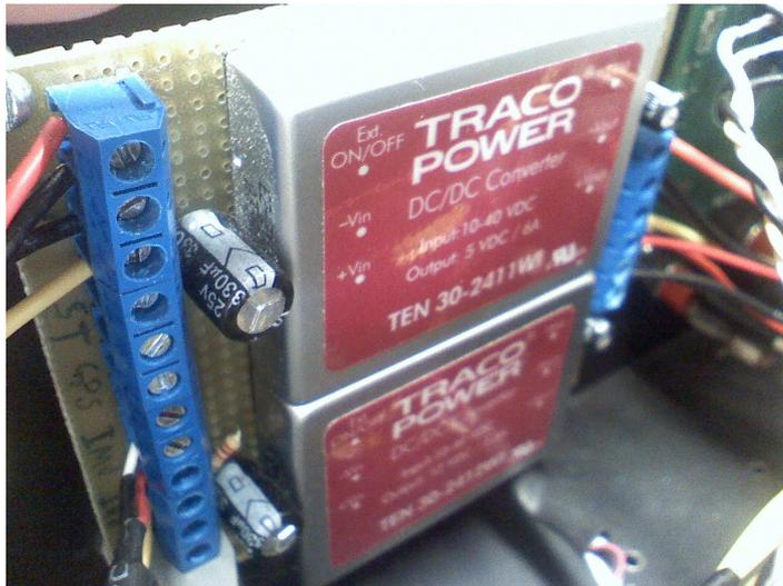
Figura 3.19: Placa de alimentação embarcada no sistema
