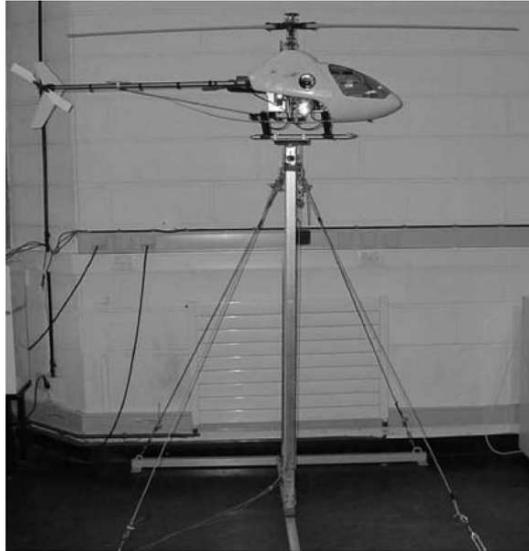
Figura 2.8: Plataforma vertical<sup>5</sup>.
