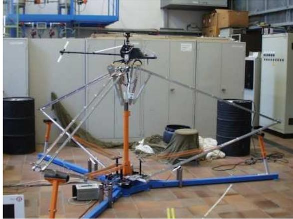
Figura 2.5: Plataforma com seis graus de liberdade<sup>2</sup>.
