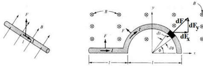
Pra o trecho reto  $F_y = IBl$  ao passo que para o semicírculo a força  $dF$  no elemento de corrente  $Ids$  fica  $dF = IBds = IB(l/2)d\phi$ . Note pela simetria que as componentes da força na direção  $x$  se cancelam resultando:
