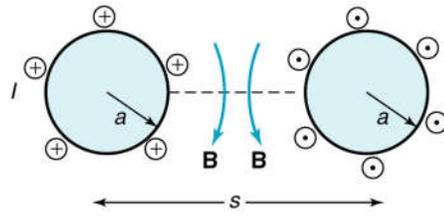
A indutância de um trecho de linha de comprimento  $d$  fica:
