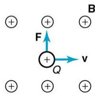
Força em uma carga pontual devido a uma campo elétrico e força devido a uma campo magnético.
